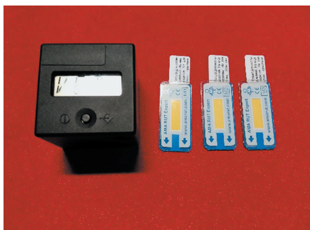
Рис. 3. Портативный анализатор активности уреазы в биологических жидкостях «AMA RUT Reader»
